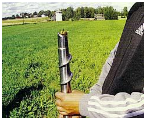
Näytekaiva ottaa rehunäytteen 1 metrin syvyyteen asti. Kuva Jaakko Helminen.
